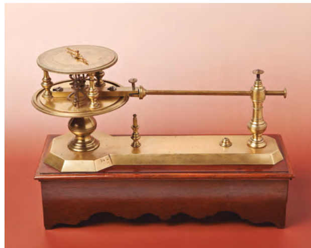
Errege Mintegiko gailu zientifiko bat: dilatometroa
